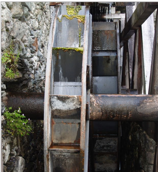
Le ruote idrauliche in ferro del tipo "a cassette per di sopra" (foto: U. Zecca)
